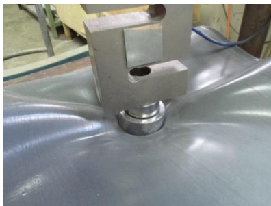
ENSAYO DE RESISTENCIA A LA COMPRESIÓN PUNTUAL CICLOS
