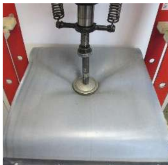
ENSAYO DE RESISTENCIA A LA COMPRESIÓN PUNTUAL
